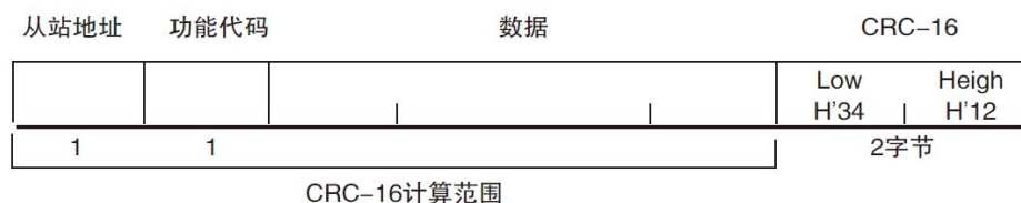
图 9- 1 Modbus 附加 CRC-16 值
